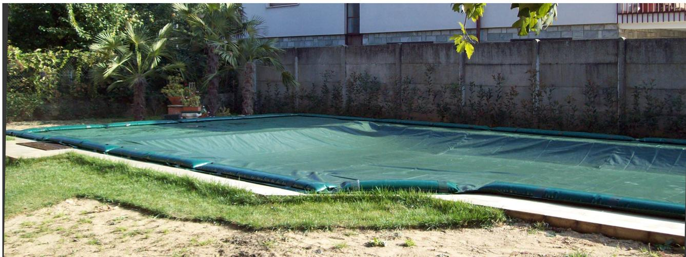
GEOMEMBRANA SINTETICA IN POLIETILENE RINFORZATO per la copertura per la chiusura invernale delle piscine, di colore verde / nero, prodotta con spalmatura in polietilene a bassa densità (LDPE) su entrambi i lati e rinforzata con un'armatura interna in tessuto di polietilene ad alta densità (HDPE).
